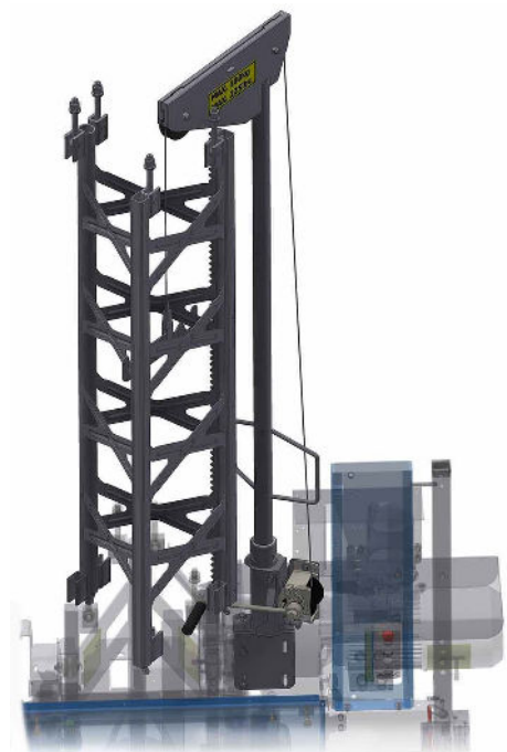
Abb. 96: Anheben, Positionieren von Mastteilen
