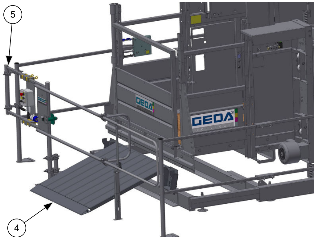
Abb. 52: Auffahrrampe am Bühnenzugang Bodenstation
