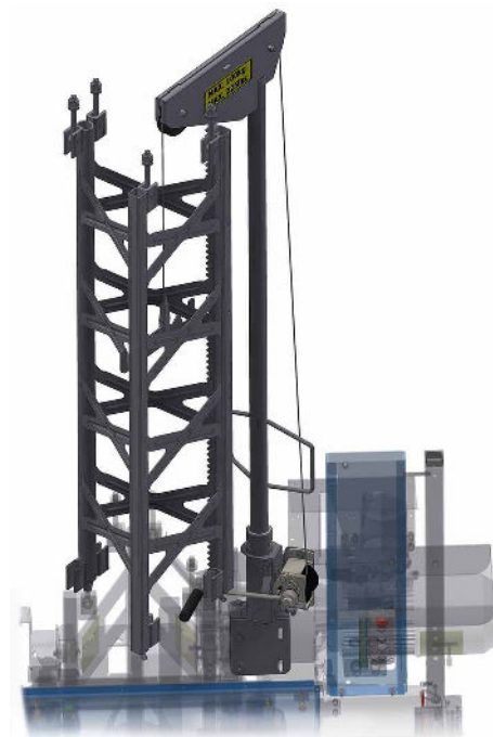
Abb. 69: Anheben, Positionieren von Mastteilen
