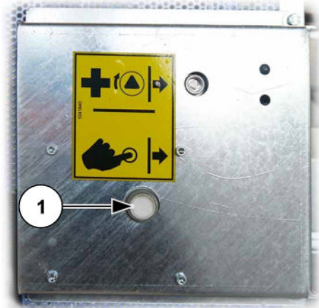
Abb. 19: Schiebetür Schloss entriegeln
