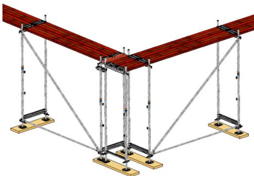
Bild 19: Eckausbildung mit drei Vertikalrahmen
