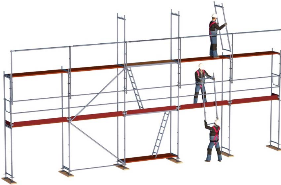
Bild 30: Montage der Gerüstlage im Schutze des MSG.
