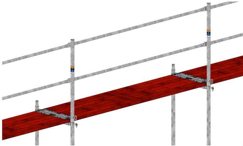
Bild 44: Oberer Abschluss mit Geländerpfosten mit Traversen.
