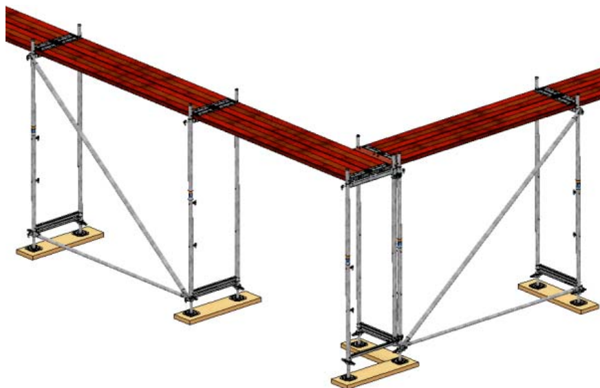
Bild 18: Eckausbildung mit zwei Vertikalrahmen
