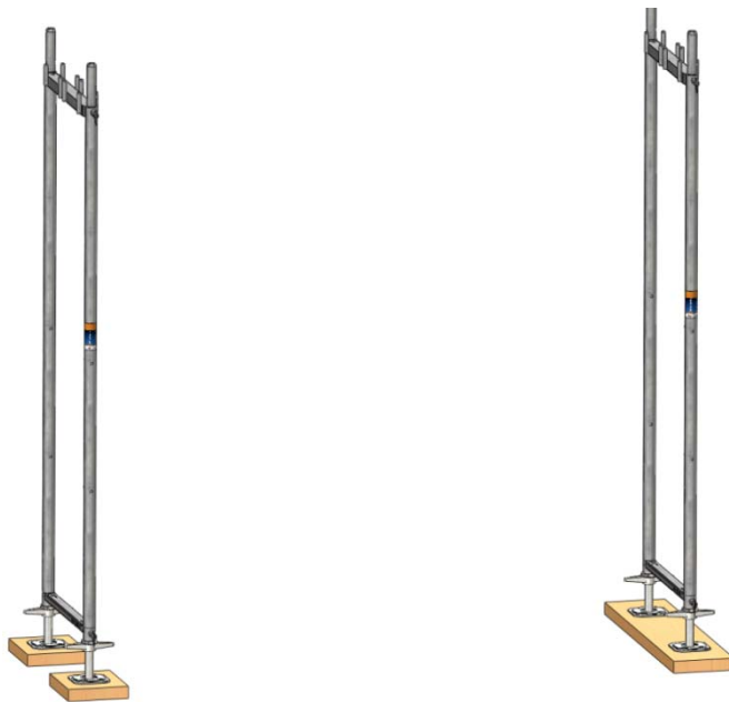
Bild 6: Aufbau des ersten Gerüstfeldes: Vertikalrahmen
