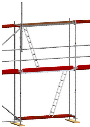
Bild 26: Montage des ersten MSG-Pfostens.
