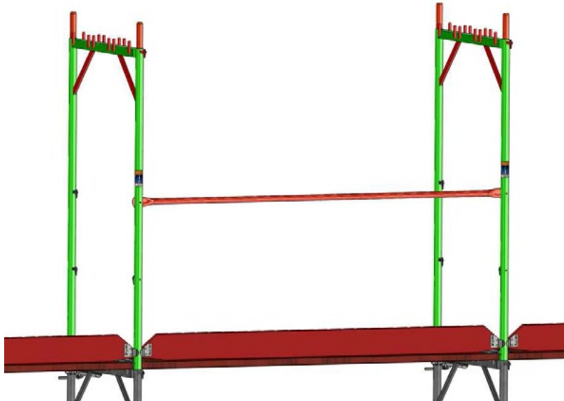
Bild 21: Zulässige Anschlagpunkte für die PSAgA am Vertikalrahmen.
