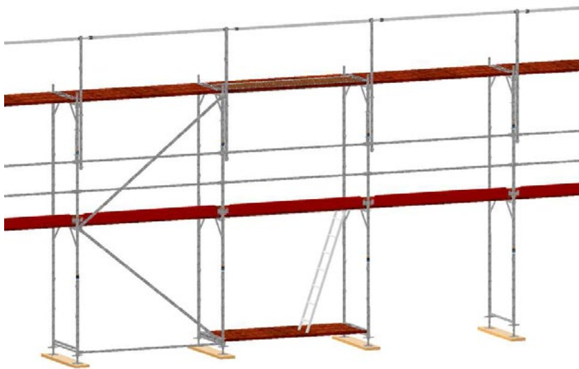
Bild 29: Montage der weiteren MSG- Einheiten
