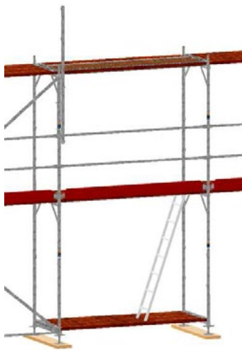
Bild 26: Montage des ersten MSG-Pfostens.
