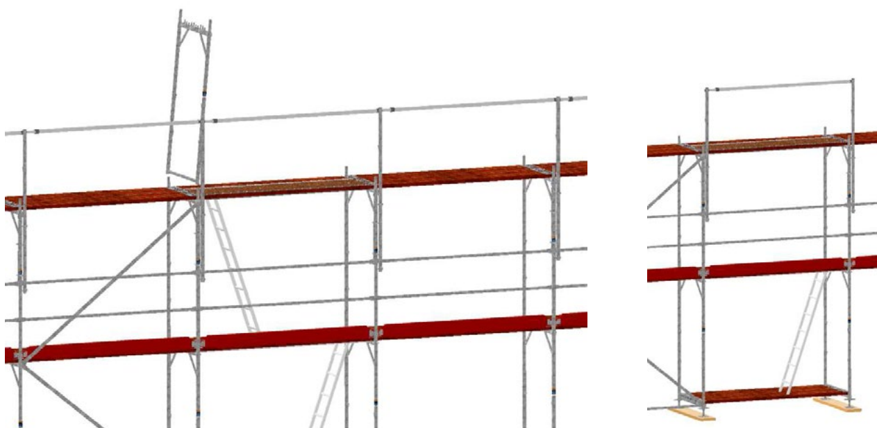
Bild 31: Aufstecken eines Vertikalrahmens.
