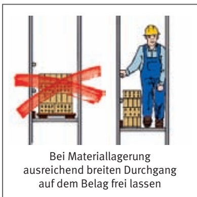
Gerüstbeläge nicht überlasten
