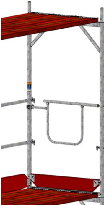
Bild 33: Stirngeländer montiert, offenes Rohrende auf einen Kippstift aufgesteckt.
