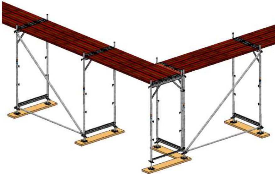
Bild 18: Eckausbildung mit zwei Vertikalrahmen
