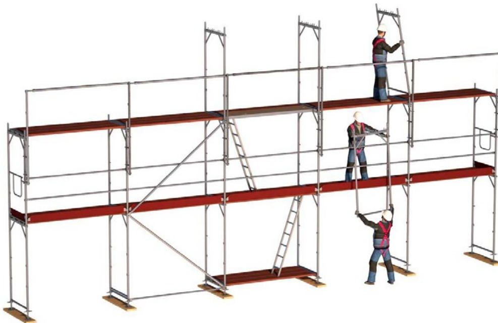
Bild 25: Beispiel für den Vertikaltransport von Hand.
