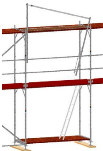
Bild 27: Einhängen des MSG-Geländers und zweiten MSG-Pfosten koppeln.
