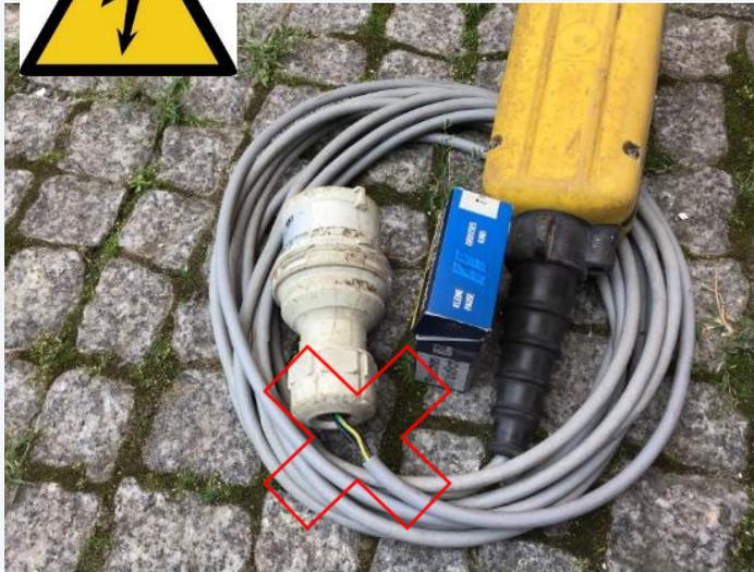
Bei Störungen sofort **Spannung abschalten** und Stecker ziehen.
