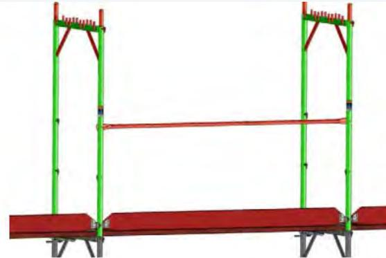
Bild 21: Zulässige Anschlagpunkte für die PSaGA am Vertikalrahmen.
