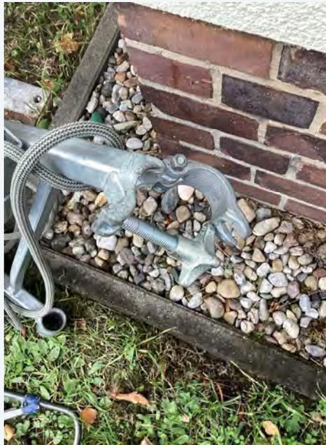
Schwenkarm der Winde mit der Kupplung gegen ausheben sichern
