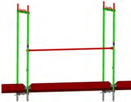
Bild 21: Zulässige Anschlagpunkte für die PSaGA am Vertikalrahmen.
